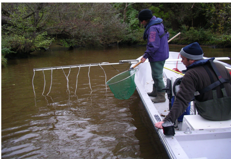
Bild 2: Beispielbild einer Streifenanode mit Seitenausleger und einem nicht-elektrisierten Kescher am Arbeitsboot.
