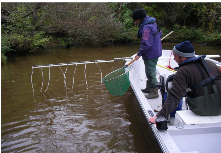
Bild 2: Beispielbild einer Streifenanode mit Seitenausleger und einem Kescher am Arbeitsboot.
