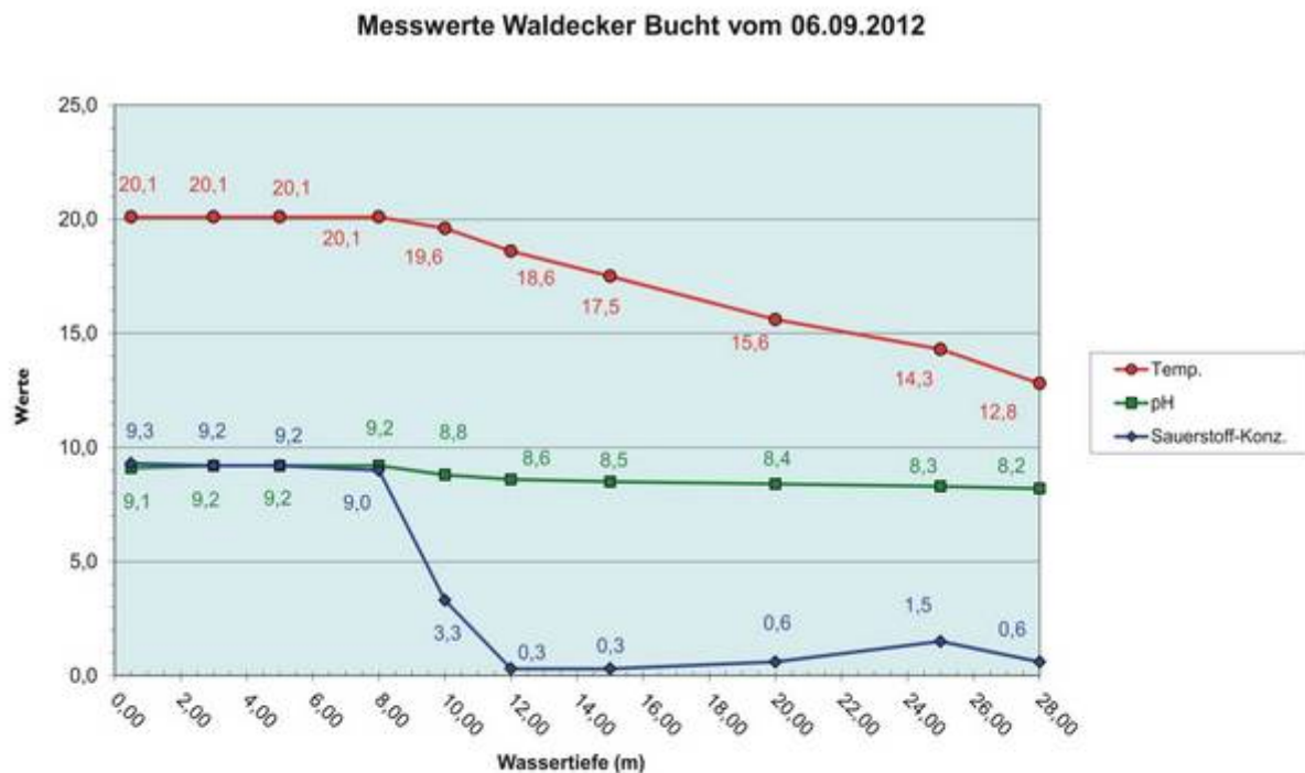
Bild 16 : Wasserbedingungen im Bereich vor der Sperrmauer
